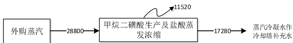
图 4.7-1 本次改建项目蒸汽平衡图（t/a）
